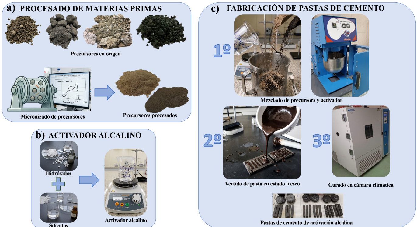
Figura 2. Procedimiento experimental: a) Procesado de materias primas (precursores); b) Fabricación activador comercial alcalino; c) Fabricación de pastas de cemento de activación alcalina
