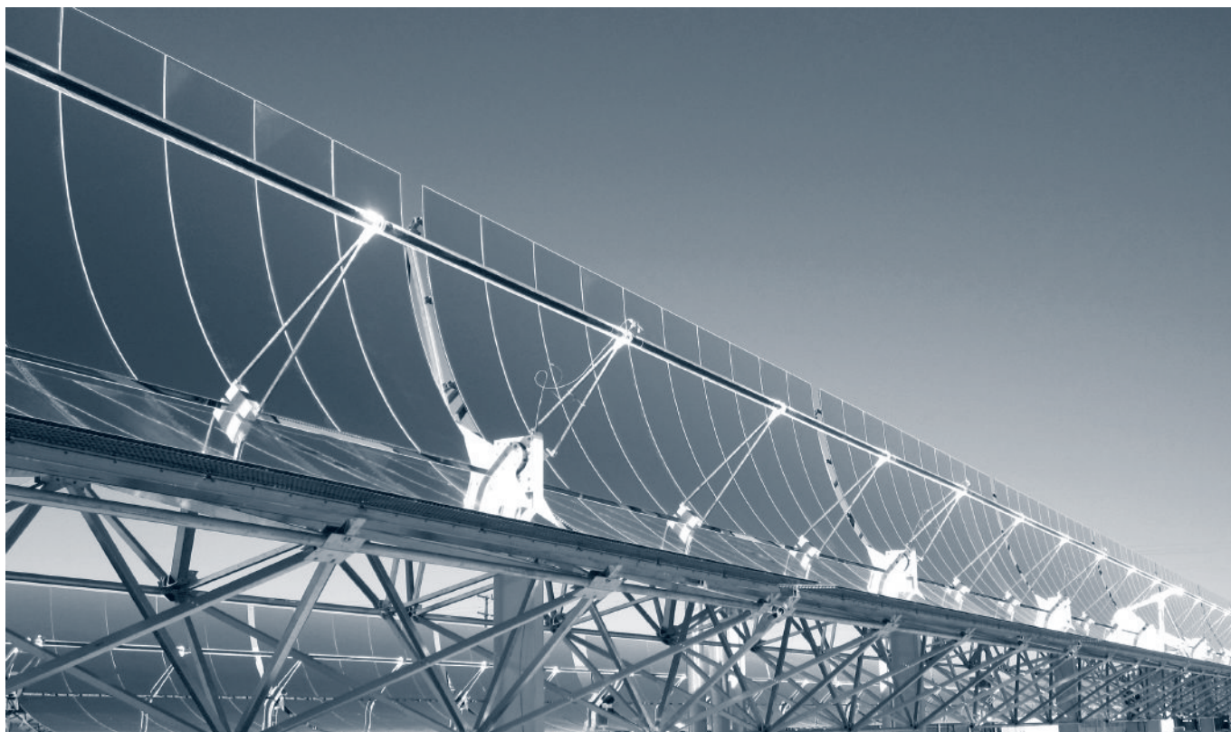
Figura 1. Colector solar cilindro-parabólico, ejemplo de invención.
