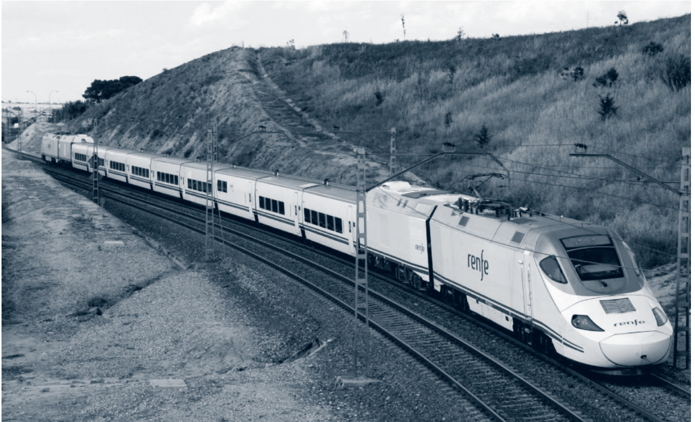
Arriba, fig. 10 . Talgo 250H circulando con pantógrafo arriba. Derecha, fig. 11 . Motor diesel del grupo generador.
