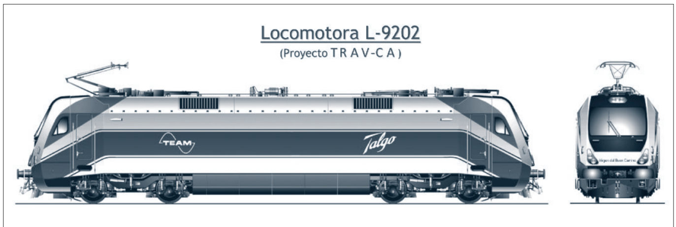
Arriba, fig. 2. Tren Talgo TEE con cambio automático de ancho de vía. Abajo, fig. 3. Locomotora Talgo eléctrica, primera en el mundo, con cambio automático de ancho de vía.
