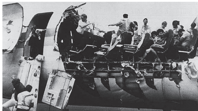
Figura 1: Desprendimiento de fuselaje debido a corrosión y fatiga del metal, producido a 7.300 metros.
