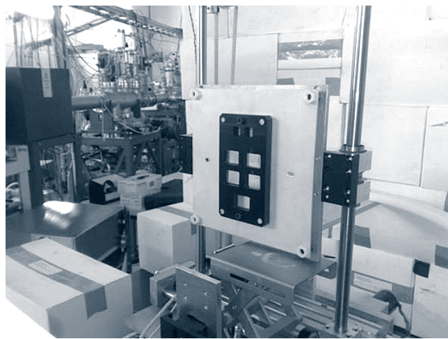
Ilustración 9: A la izquierda, una fotografía de una de las redes de difracción holográficas de volumen empleadas en el desarrollo del espectrómetro SPU. A la derecha, una fotografía de la campaña de irradiación con protones de la red de difracción realizada en el PIF (Proton Irradiation Facility), en Finlandia.
