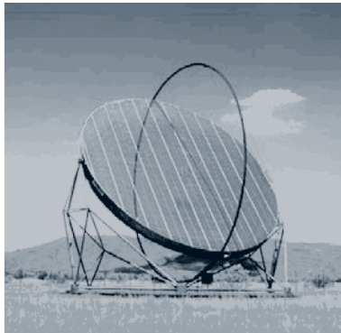
Heliostato tipo carrusel
