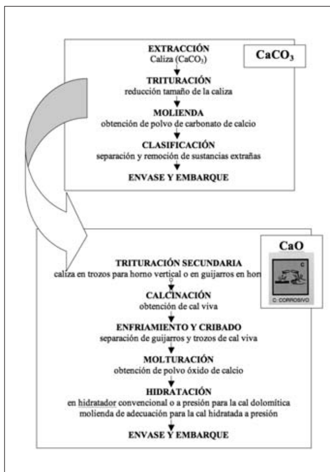
Figura 1: Esquema de producción de \text{CaCO}_3 y \text{CaO}
