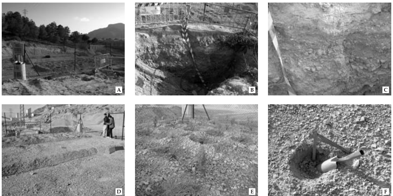
Figura 3. Diversos aspectos de la parcela experimental. A) Vista general de la parcela experimental; B y C) Detalles de los materiales de relleno sobre los que se instaló la parcela experimental; D) Vista de las subparcelas; E) Detalle de una subparcela una vez implantada la vegetación; F) Toma de muestra para posterior análisis en laboratorio.
