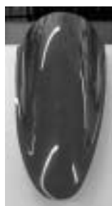
Figura 7. Parte delantera de una carcasa de aislamiento electromagnético (terminación con Gel Coat de color verde).
