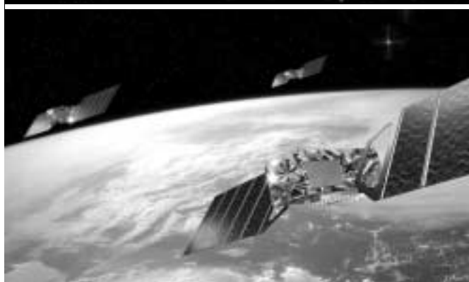
Esquema orbital del Sistema Galileo que cuenta con treinta satélites distribuidos en tres órbitas.
