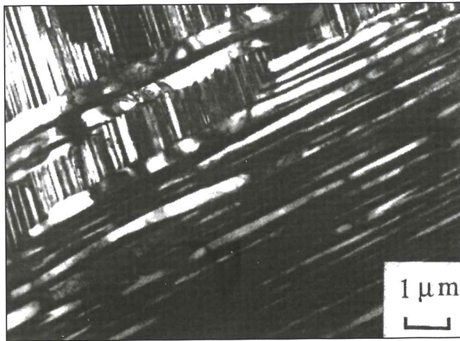
Fig.3 Microestructura laminar de aleaciones bifásicas TiAl/Ti 3 Al.
